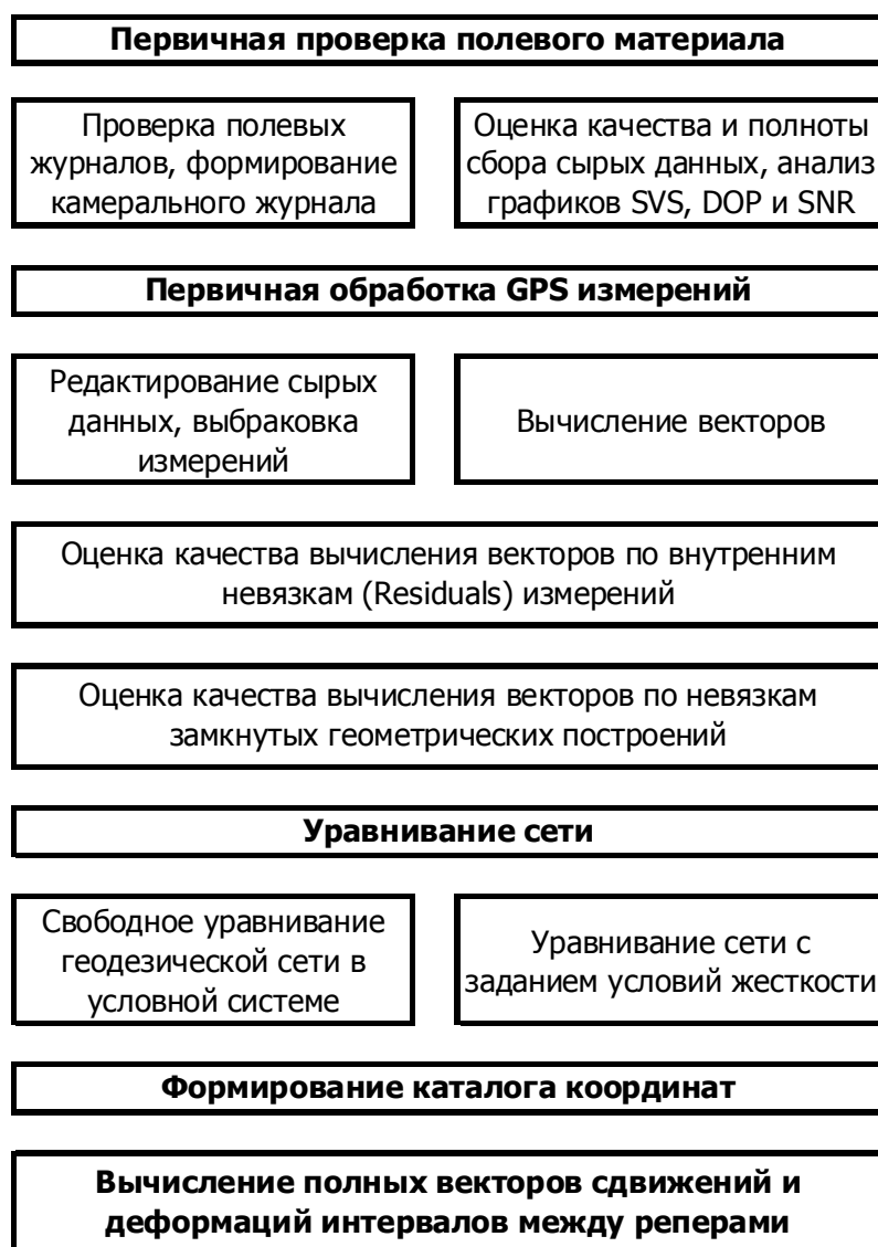
Рисунок 22 – Блок-схема выполнения камеральной обработки результатов полевых инструментальных измерений
