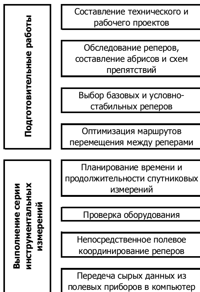
Рисунок 20 – Блок-схема выполнения полевых инструментальных измерений
