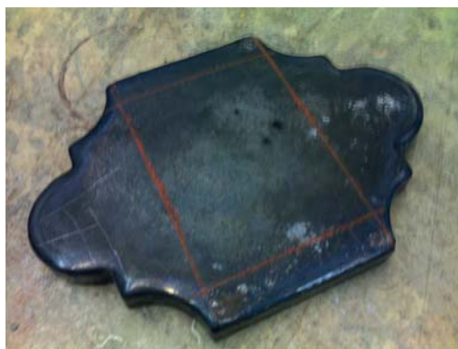
Рис. 3. Камнелитое изделие на основе базальта
