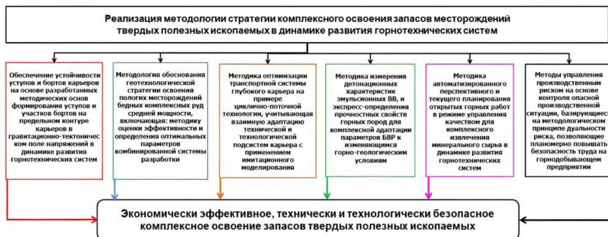
Рисунок 1 - Блок-схема взаимосвязанных процессов горного производства
