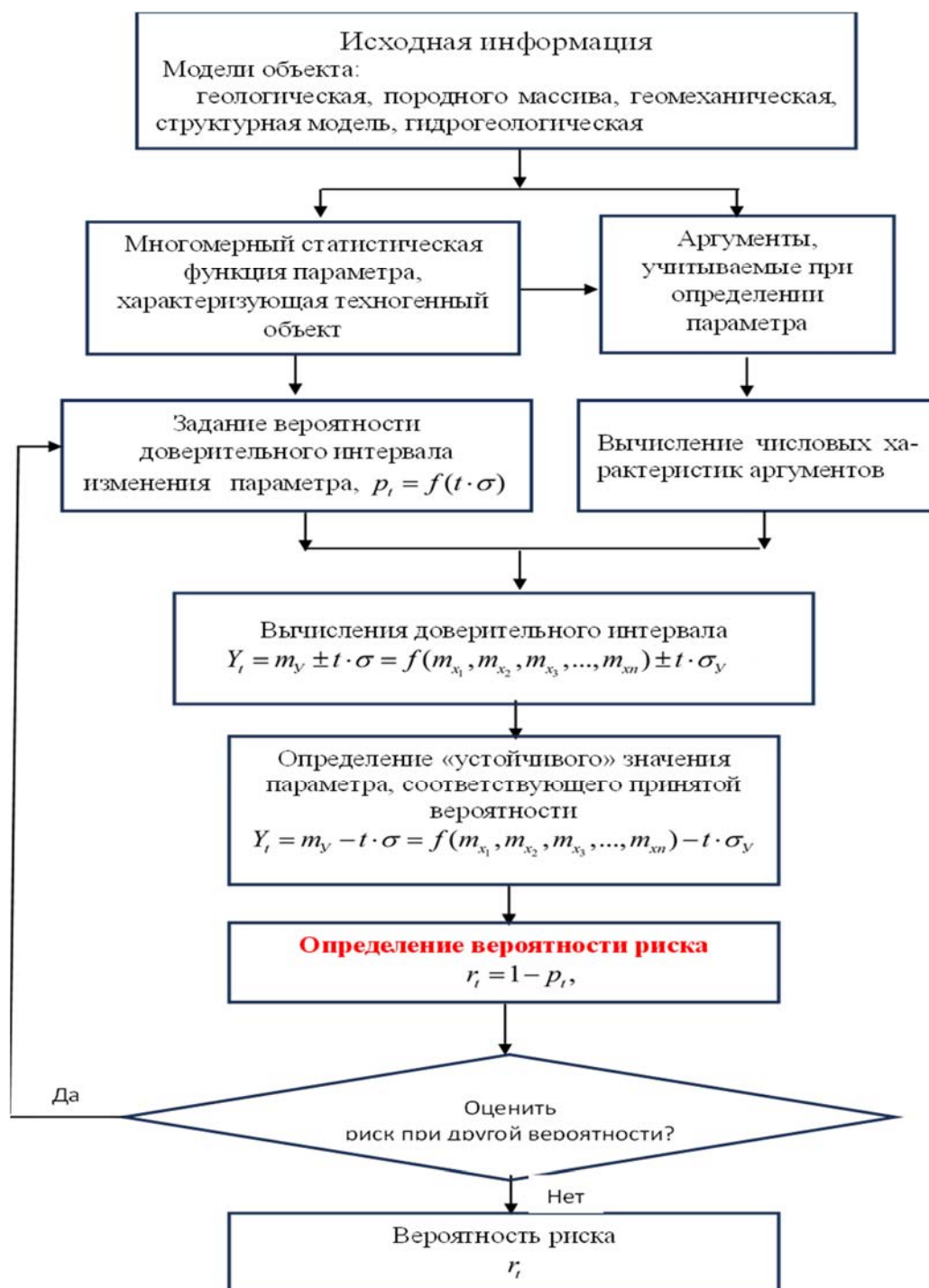
Рисунок 16 - Блок-схема определения вероятной оценки техногенного риска на техногенном объекте
