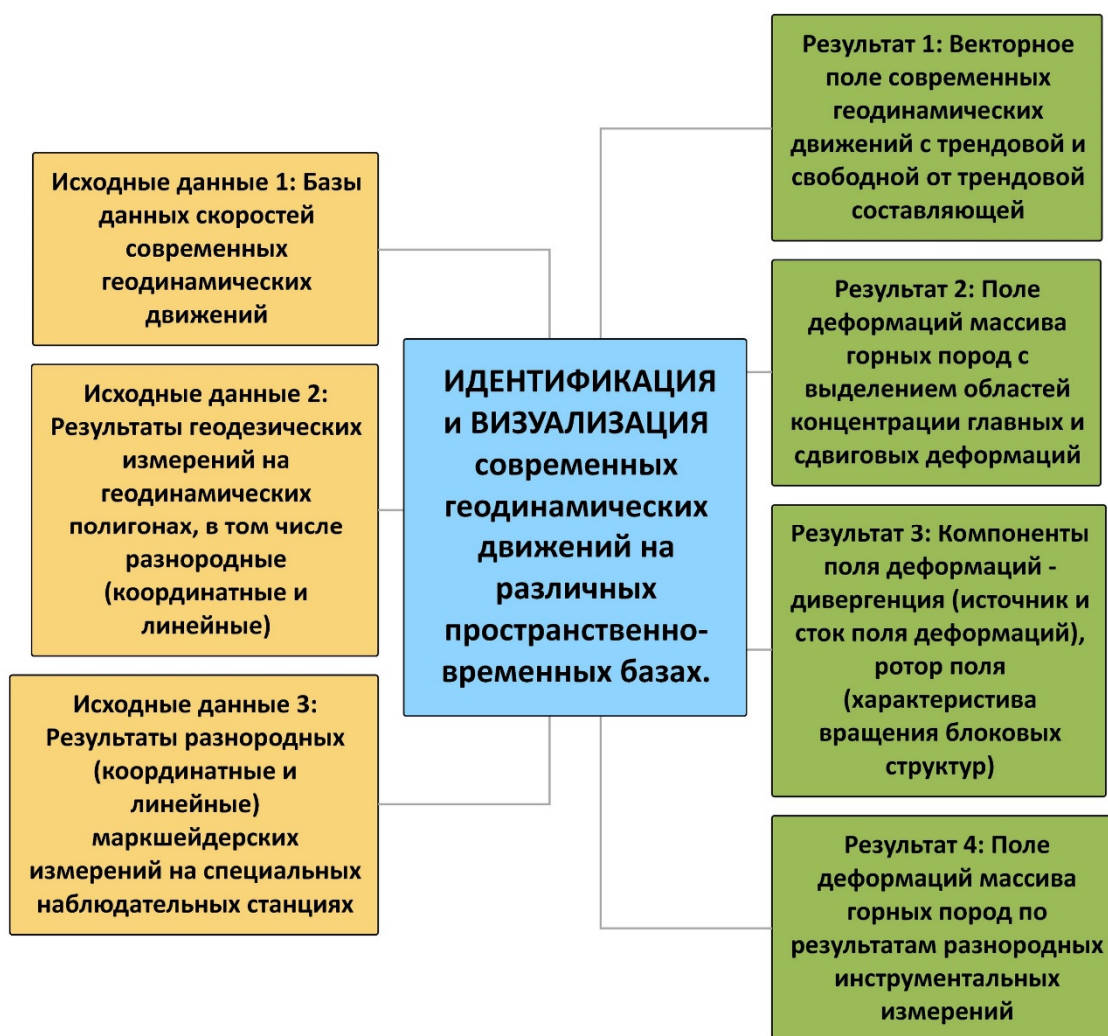
Рисунок 22 – Методика идентификации и визуализации современных геодинамических движений
