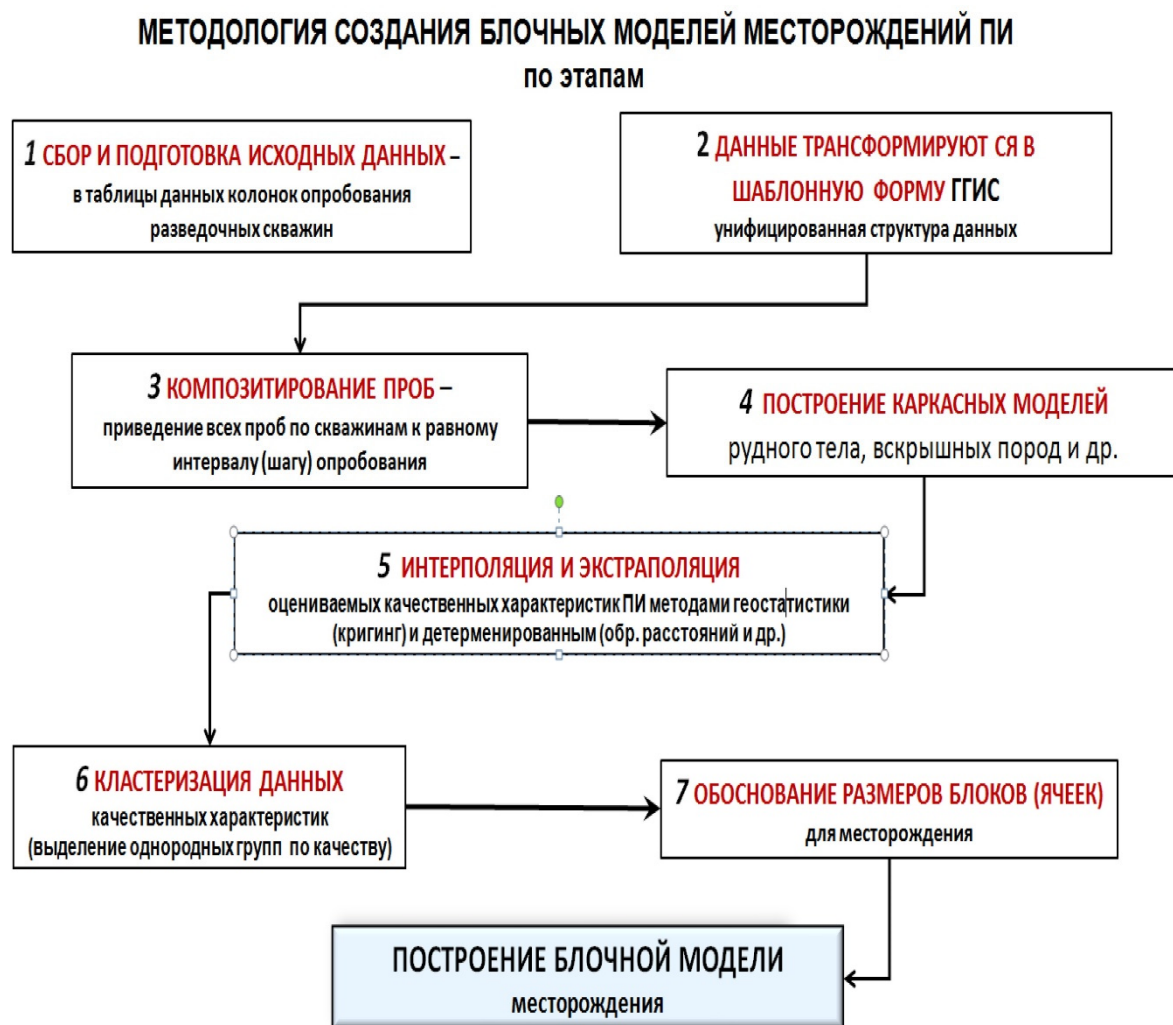
Рисунок 3 – Методика создания блочных моделей месторождений полезных ископаемых
