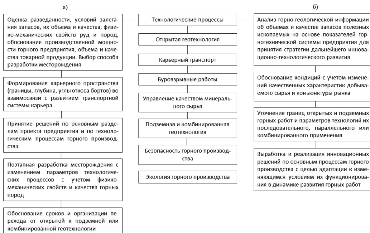
Рисунок 1 - Наиболее значимые вопросы, решаемые при проектировании глубокозалегающих месторождений (а), и постановка проблем развития действующих горных предприятий (б), требующие исследования переходных процессов
