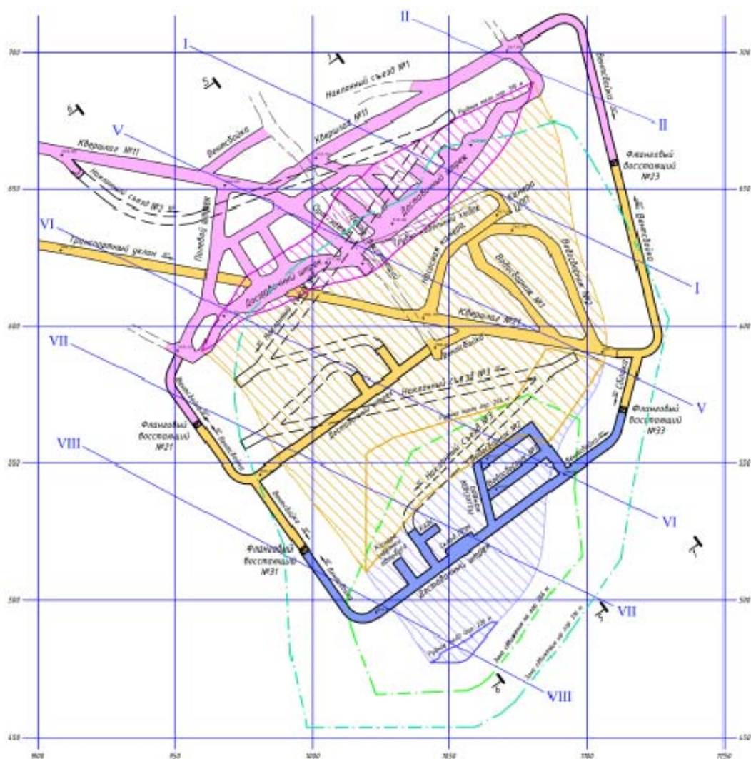
Рисунок 23 – Схема вскрытия (совмещенный план горизонтов) этажа 316/216м
