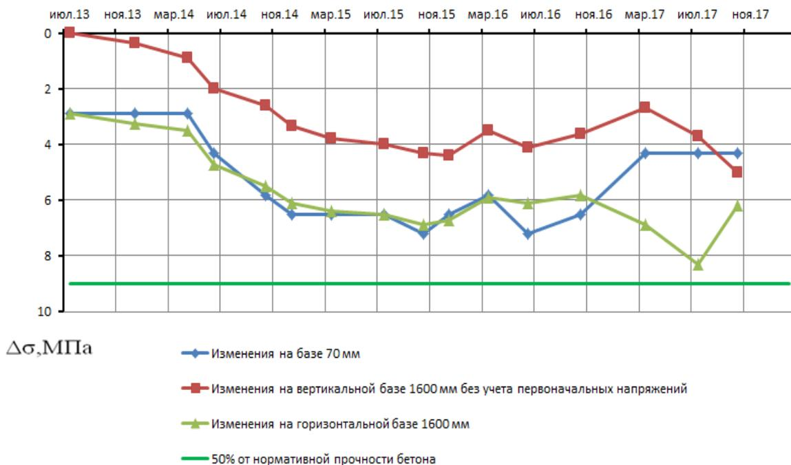
Рисунок 25 - График изменения напряжений в бетонной крепи ствола шахты «Клетевая» на горизонте -830 м
