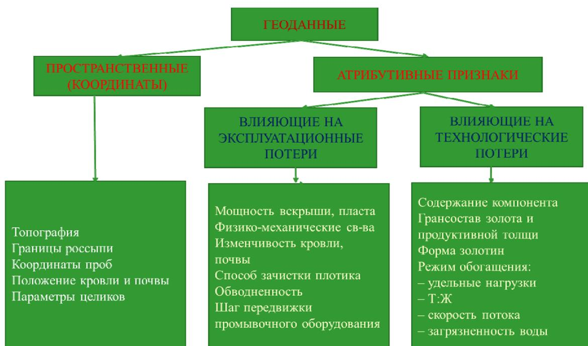
Рисунок 15 – Структура геоинформационного обеспечения мониторинга горно-технологического объекта
