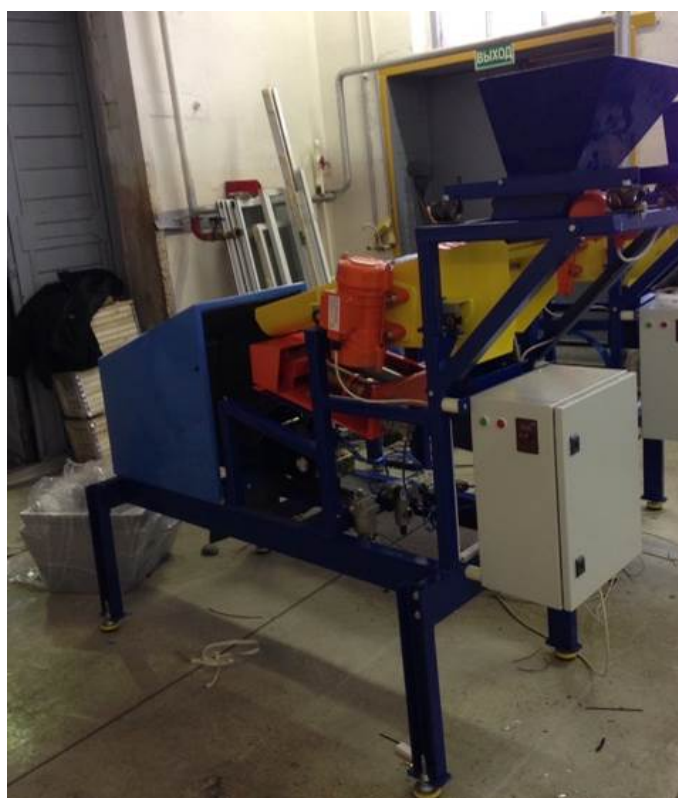
Рисунок 18 – Экспериментальный образец сепаратора СРФ1-150Л
