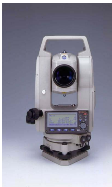
Цифровой тахеометр Sokkia NET1200
