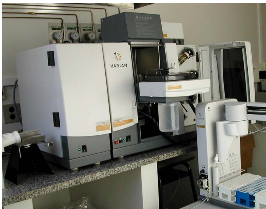
Атомно-абсорбционный спектрометр Varian AA240FS
