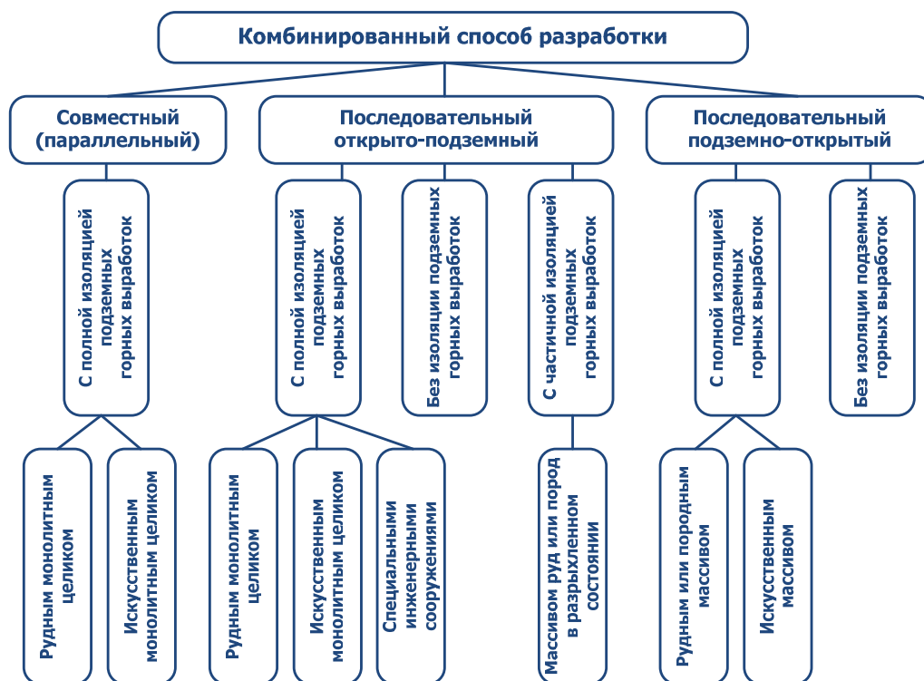
Рис. 9. Классификация комбинированного способа разработки месторождений
