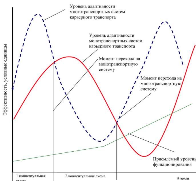
Рис. 22. Схема смены парадигм формирования транспортных систем карьеров
