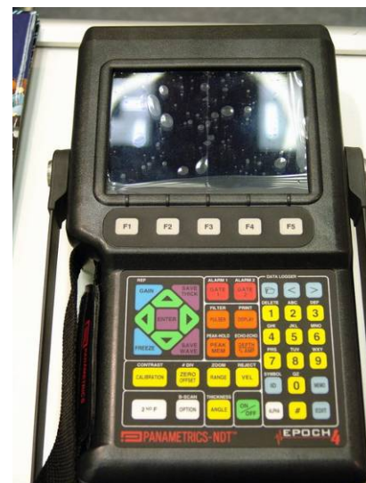
Ультразвуковой дефектоскоп EPON 4 PLUS
