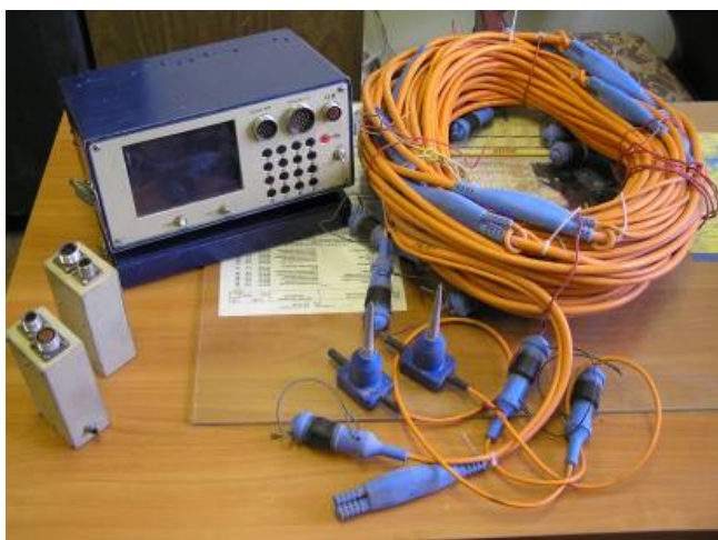
Сейсмическая станция с накоплением «СИНУС-12М»
