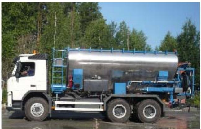
**Предназначена** для транспортирования компонентов эмульсионного взрывчатого вещества типа порэмит, приготовления его в процессе заряжания и заряжания им преимущественно обводненных скважин на открытых горных работах методом "под столб воды".
