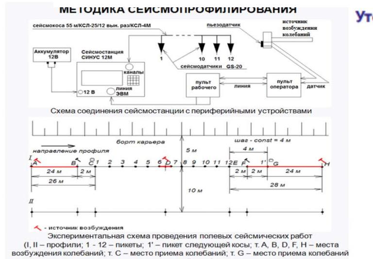
Аппаратура для сейсмопрофилирования (определение физико-механических свойств горных пород методом сейсмометрии)
