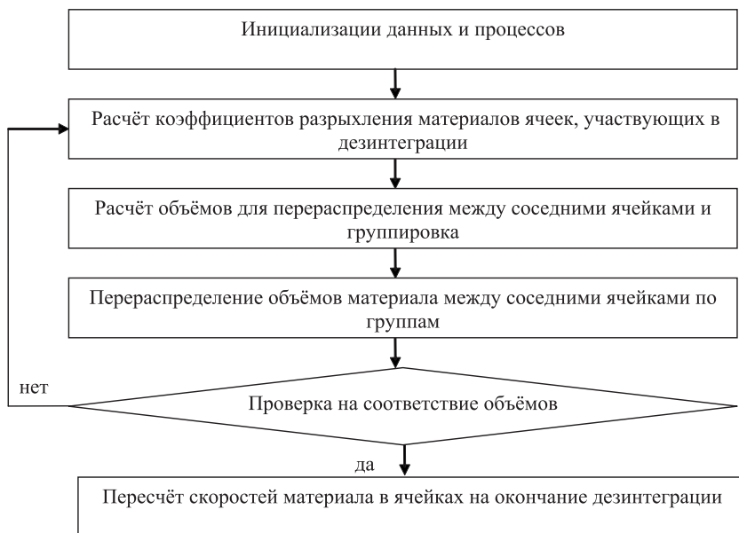
Рис. 3. Блок-схема алгоритма дезинтеграции материала
