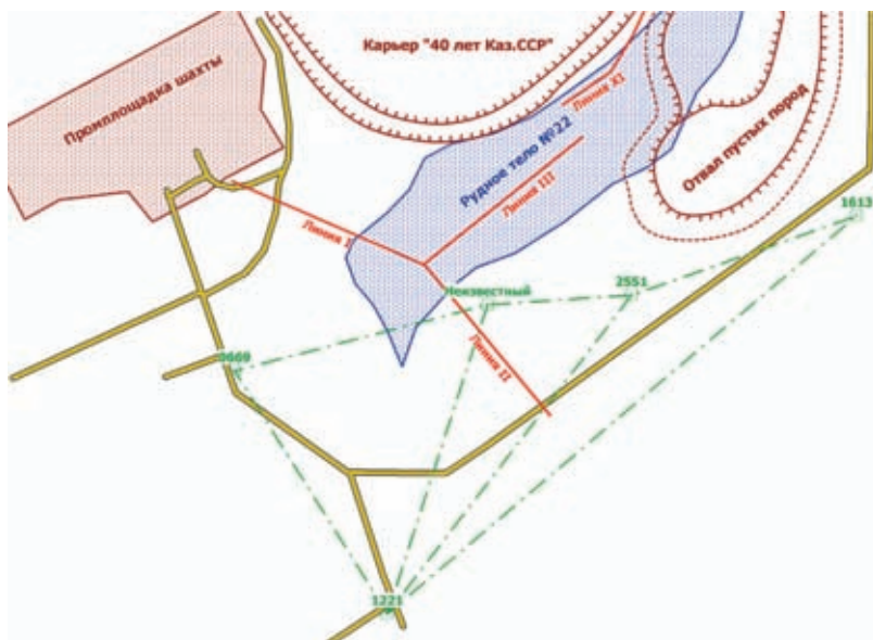
Рис. 2. Схема наблюдательной станции на месторождении
