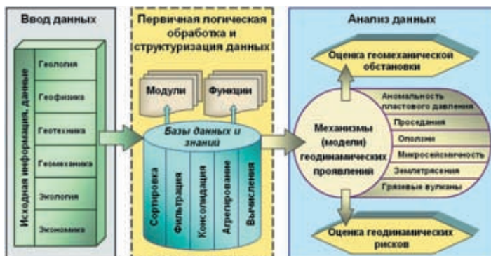
Рис.2. Структура информационного геомеханического обеспечения шельфовых нефтегазовых разработок
