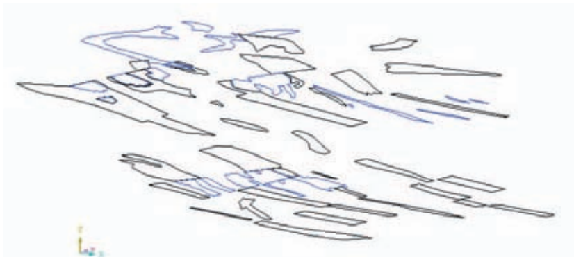
Рис. 3. Контуры рудных тел Янытурынского участка железных руд: синий – запасы C_1, C_2 ; черный – прогнозные ресурсы P_1, P_2, P_3
