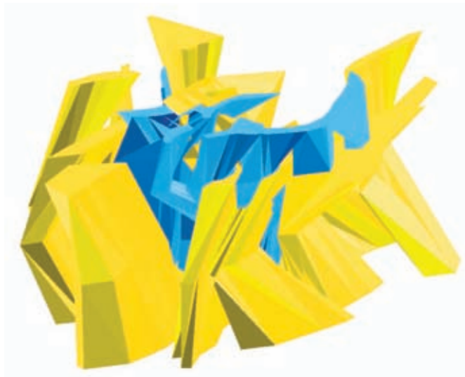
Рис. 4. Каркасные модели рудных тел Янытурынского месторождения железных руд: синий – запасы C_1+C_2 ; желтый – ресурсы P_1+P_2+P_3
