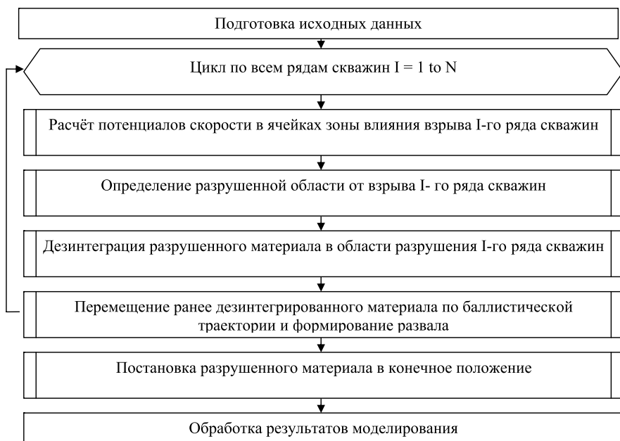
Рис. 1. Блок-схема алгоритма компьютерного моделирования взрывного разрушения при многорядном короткозамедленном взрывании
