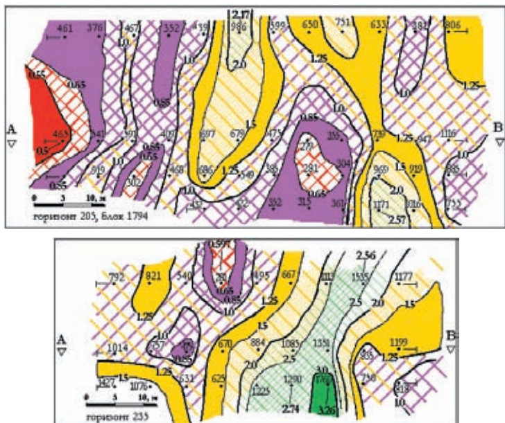
Рис. 9. Эксплуатационная разведка титано-магнетитовых руд, Северный карьер Гусевгорского месторождения (цифрами – сопротивление \rho_k , Ом·м; изолинии равных содержаний магнетита, размер (0.5, 0.65, 0.85, 1, 1.25, 1.5, 2.0, 2.5, 3.0) – параметр К, о.е., обратно пропорциональный \rho_k ; рост рудоносности отмечен изменением цвета: от зеленого, желтого к розовому, красному)
