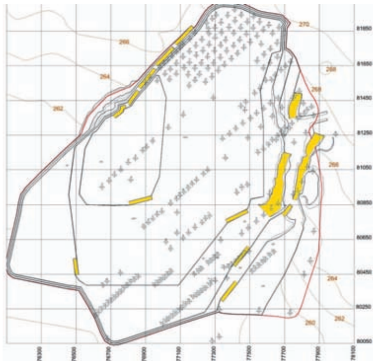
Рис. 4. Положение горных работ на карьере Шеинского месторождения известняков на 2050 г.
