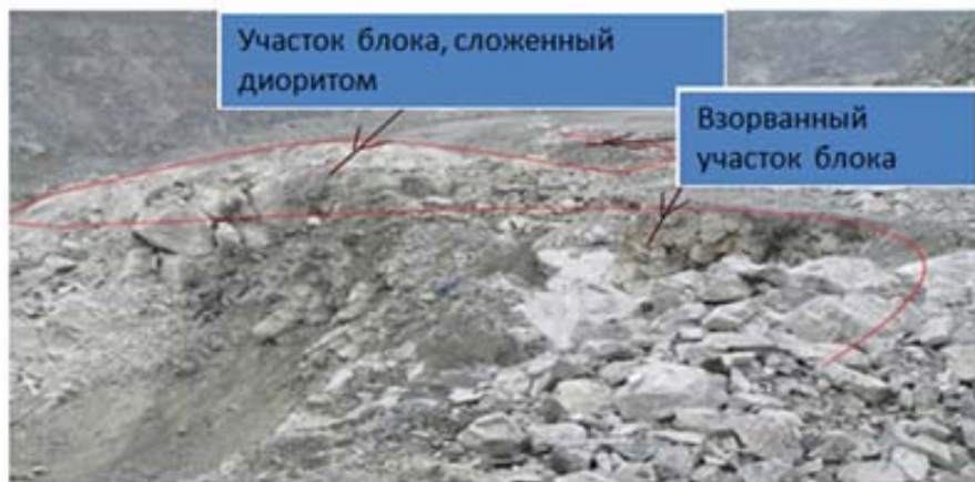
Рис. 3 – Опытный блок № 1 после взрыва с неразрушенным участком из диорита
