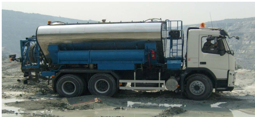
Фото 1 Смесительно-зарядная машина СЗГМ-153 на экспериментальном блоке
