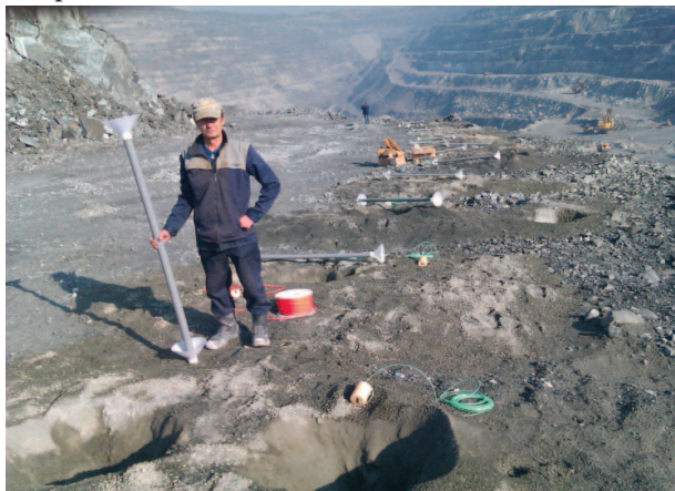
Рис. 3 – Устройство (затвор) скважинного перебура
