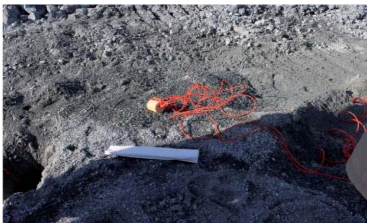
Рис. 1. Пневматическая заглушка LBP-250-18
