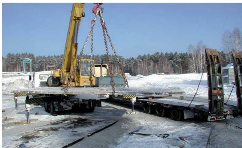
Рис. 4. Погрузка листов биметалла площадью 15,5 м<sup>2</sup> из нержавеющей и марганцовистой сталей, изготовленных сваркой взрывом с помощью ВС на основе аммиачной селитры
