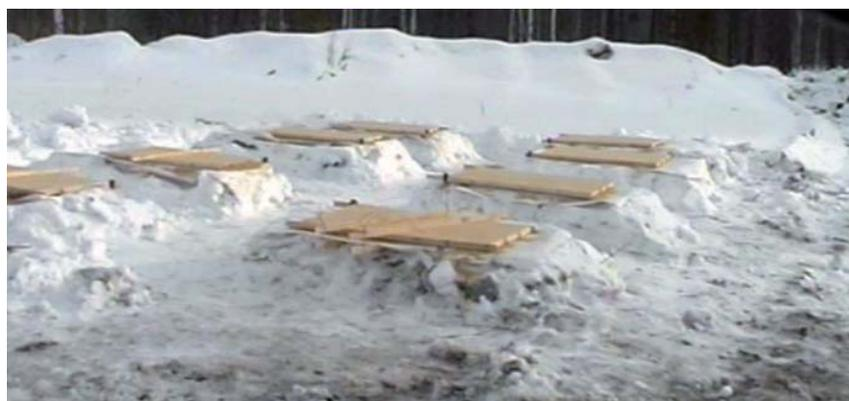
Рис. 3. Пластины из алюминия и меди, подготовленные к сварке взрывом с помощью ВС на основе аммиачной селитры
