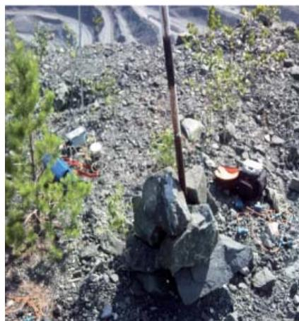
Рис. 2. Расположение сейсморегистраторов возле репера на оползневом участке на гор. +295 м на Северном борту Главного карьера (09.07.12.)
