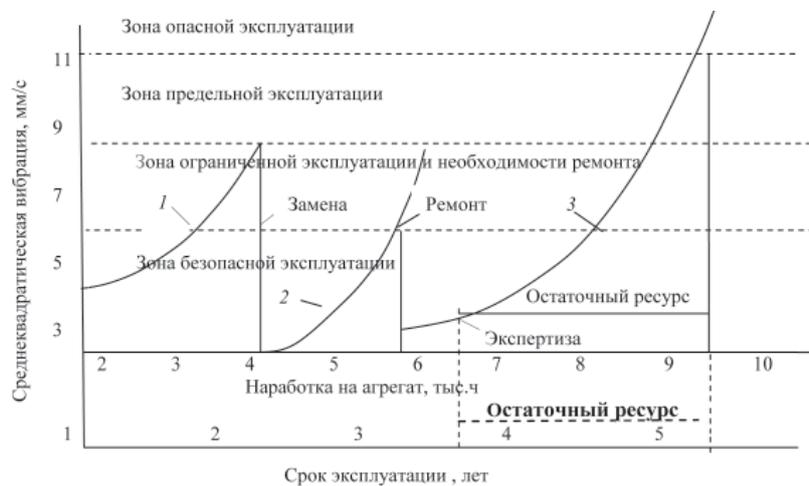
Рис. 2. Определение остаточного ресурса агрегата вращателя при проведении экспертизы промышленной безопасности
