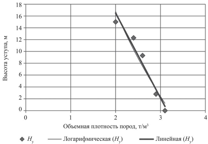
Рис. 4. Изменение объемной плотности пород по высоте уступа.
