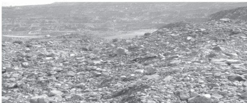
Рис. 5. Результат опытно-промышленного взрыва на карьере Южный ОАО «Ураласбест»
