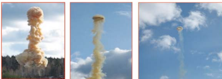
Рис. 2. Образование «кольца» при инициировании заряда из центра листа (свидетельствует о стабильности детонации)
