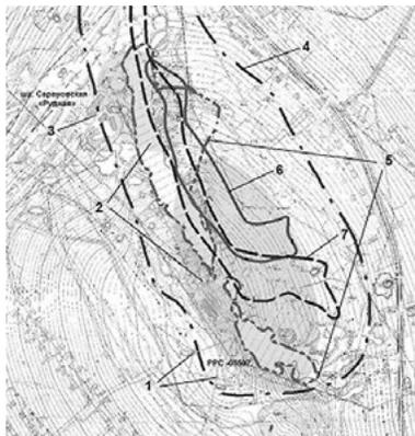
Рисунок 1 - Совмещенный план поверхности, горных работ, зоны сдвига и обрушения охраняемых объектов на Сарановском месторождении хромитов.
