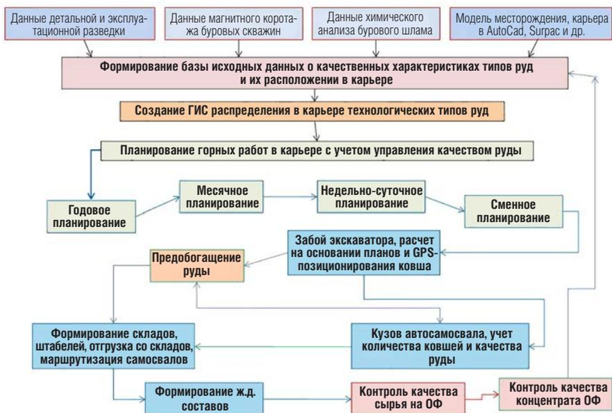
*Рисунок 6.4 – Принципиальная схема процессов адаптации горно-технологических систем при управлении качеством минерального сырья на глубокозалегающих железорудных месторождениях*
