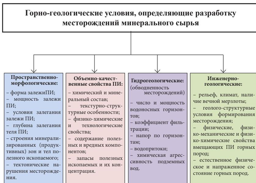
*Рисунок 6.1 – Систематизация горно-геологических условий, определяющих разработку месторождений полезных ископаемых*
