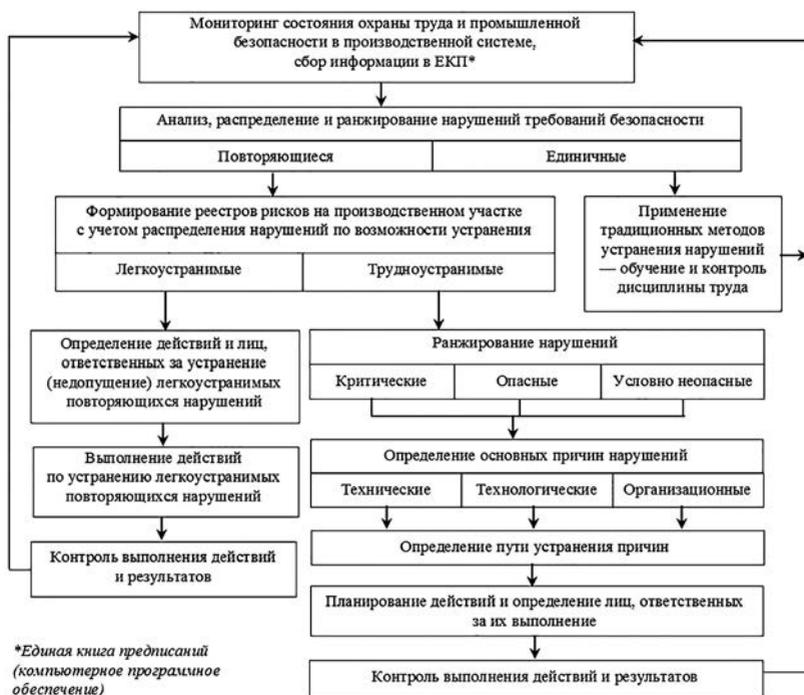
**Рисунок 7.6 – Блок-схема механизма устранения повторяющихся нарушений требований безопасности [7]**
