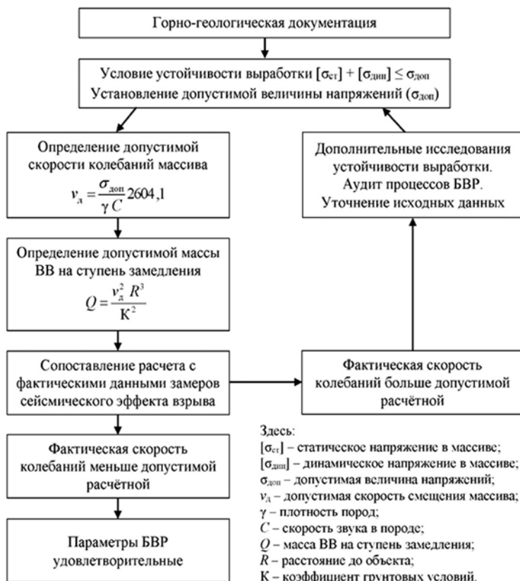
Рис. 1. Схема к анализу сейсмического действия взрыва
