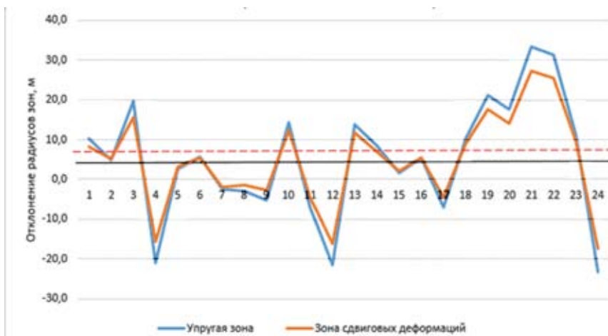
Рис. 3. Отклонения расчета по замерам от приближенного расчета по номограмме
