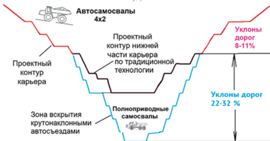
Рис. 6. Схема доработки карьера с применением вскрытия крутонаклонными автосъездами нижних горизонтов
