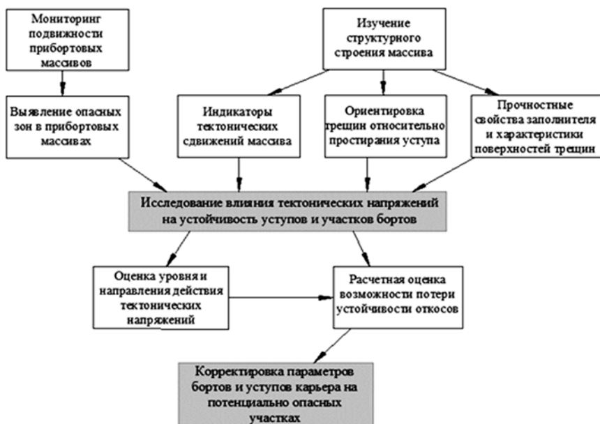
Рис. 1. Алгоритм обоснования устойчивости бортов и уступов для действующих карьеров
