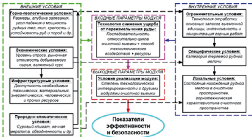
Рис. 2. Структура условий и параметров геотехнологического модуля «Снижение ущерба от переизмельчения руды»
