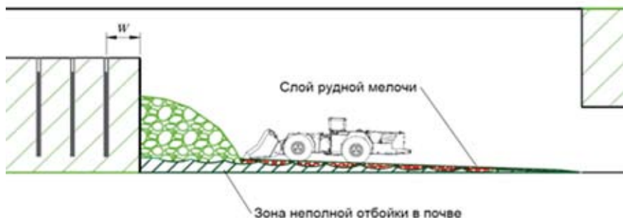
Рис. 3. Схема образования потерь обогащенной рудной мелочи и неотбитой руды в почве камеры с плоским днищем
