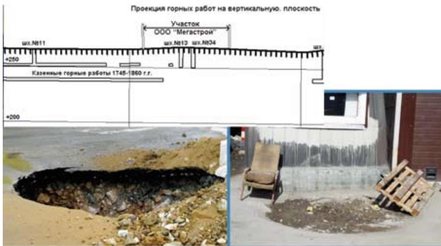
**Рисунок 4.8.** Современные проявления обрушений поверхности на территории Березовского месторождения
