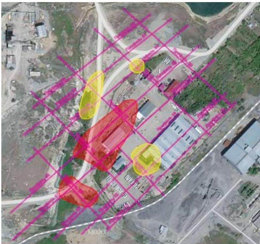
**Рисунок 3.13.** Схема расположения выявленных методом ССП дизъюнктивных нарушений горного массива промплощадки
