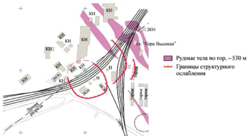
**Рисунок 4.14.** Контуры области дезинтегрированных пород по состоянию на май 2009 г., определенные методом спектрального сейсмопрофилирования. Здесь и на рис. 4–6 принято: 4 КЖ — четырехэтажное, каменное, жилое (цифра обозначает этажность, вторая буква — тип материала стен, третья буква — жилое/нежилое); 3КН — трехэтажное, каменное, нежилое; разв. — развалины
