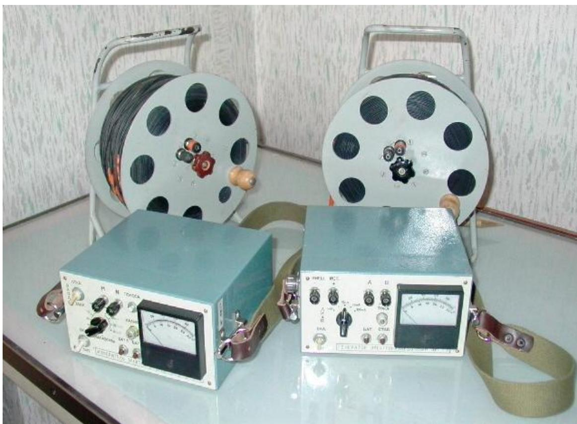
Рисунок 3.3 – Комплект аппаратуры для электроразведки «Березка»
