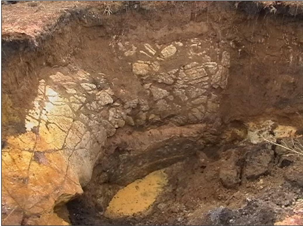
Рисунок 2.1 – Обнажение закарстованного массива как пример иерархически блочной структуры
