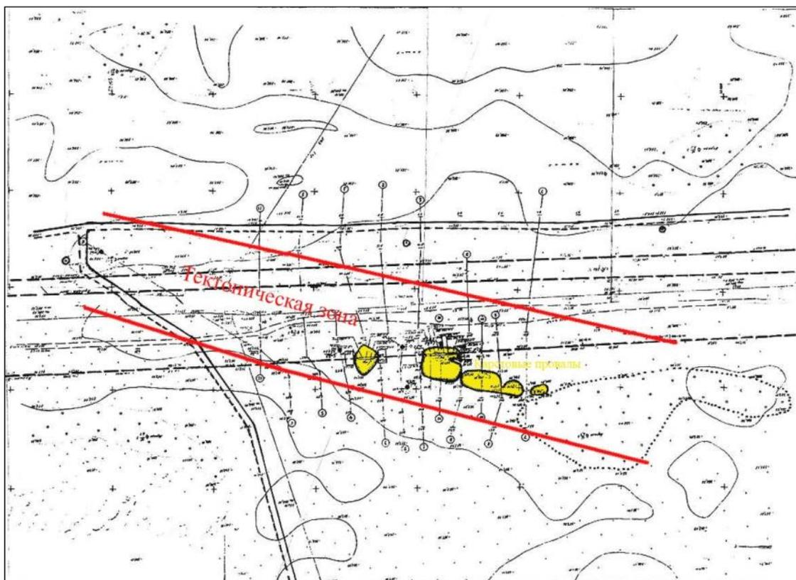
Рисунок 2.3 – Схема развития карста на участке газопровода
