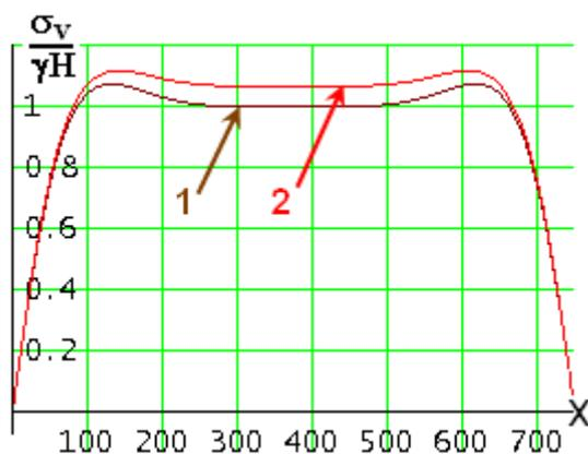
Рис. 3.3. Эпюра вертикальной нагрузки по длинной оси шахтного поля: 1 – по центру (при  $y = 250$  м); 2 – по максимальным значениям (при  $y = 125$  м)
