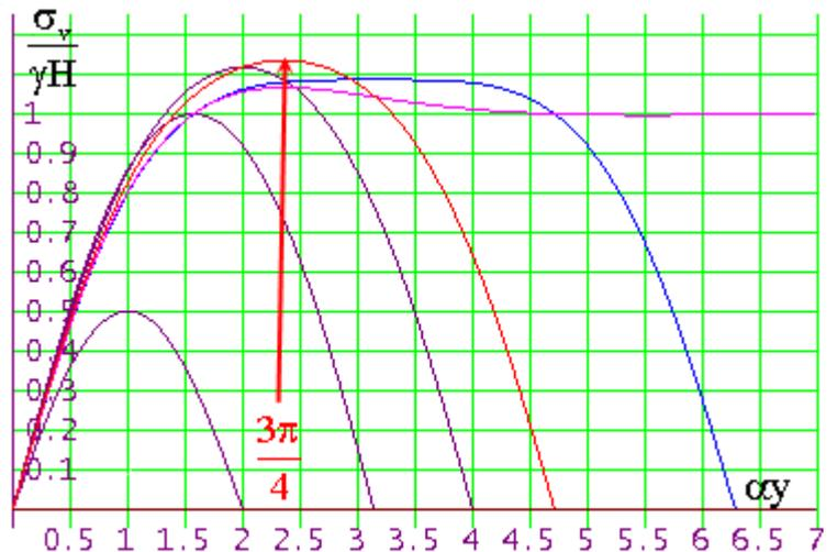
Рис. 3.18. Изменение нагрузки на поддерживающие целики при увеличении размеров шахтного поля
