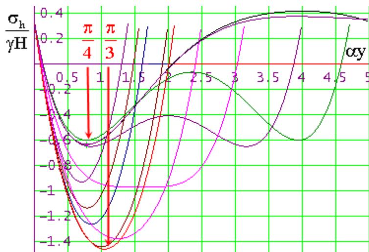
Рис. 3.20. Изменение горизонтальных напряжений в потолочине при увеличении размеров шахтного поля
