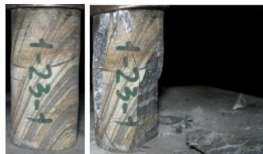
Рис. 1.10. Разрушение полосчатого кварцита
