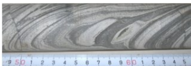
Рис. 1.7. Трещины III–IV систем в магнетитовых кварцитах с прослоями силикат магнетита
