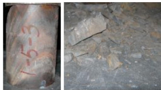
Рис. 1.9. Разрушение «взрывного» типа окисленного кварцита
