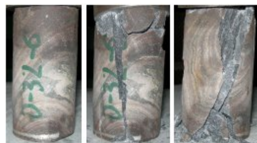
Рис. 1.12. Разрушение магнетитового кварцита с куммингтонитом, с железной слюдкой
