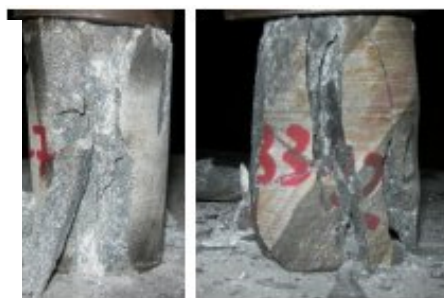
Рис. 1.11. Разрушение магнетитовых кварцитов
