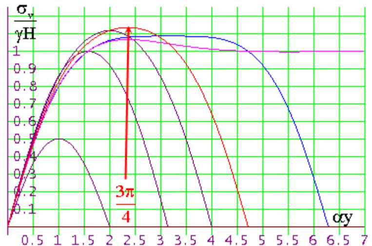
Рис. 7. Изменение нагрузки на поддерживающие целики при увеличении размеров шахтного поля
