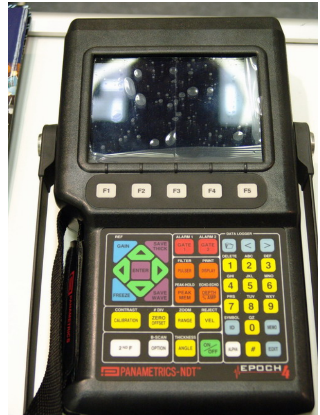
Ультразвуковой дефектоскоп EPOCH 4 PLUS
