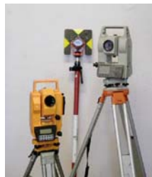
Электронные тахеометры фирм Sokkia и УОМЗ (SET 310 и ЗТА5) Лазерный дальномер фирмы Sokkia (DiSTO)
