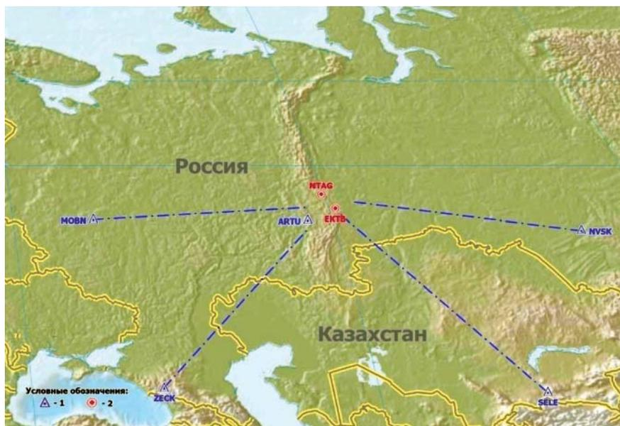
Рис. 4. Схема привязки постоянно действующих GPS-станций к глобальной геодезической сети: 1 – пункты глобальной сети IGS; 2 – локальные постоянно действующие GPS-станции
