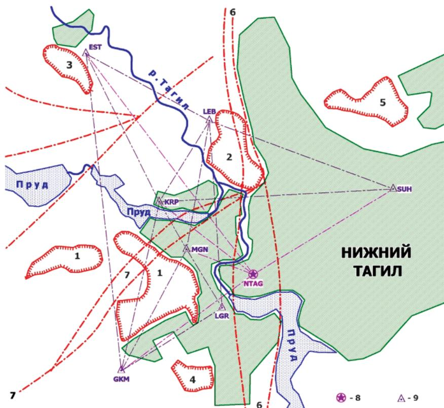
Рис. 2. Схема расположения техногенных объектов, тектонических нарушений и узловых реперов геодинамического полигона г. Нижний Тагил:
