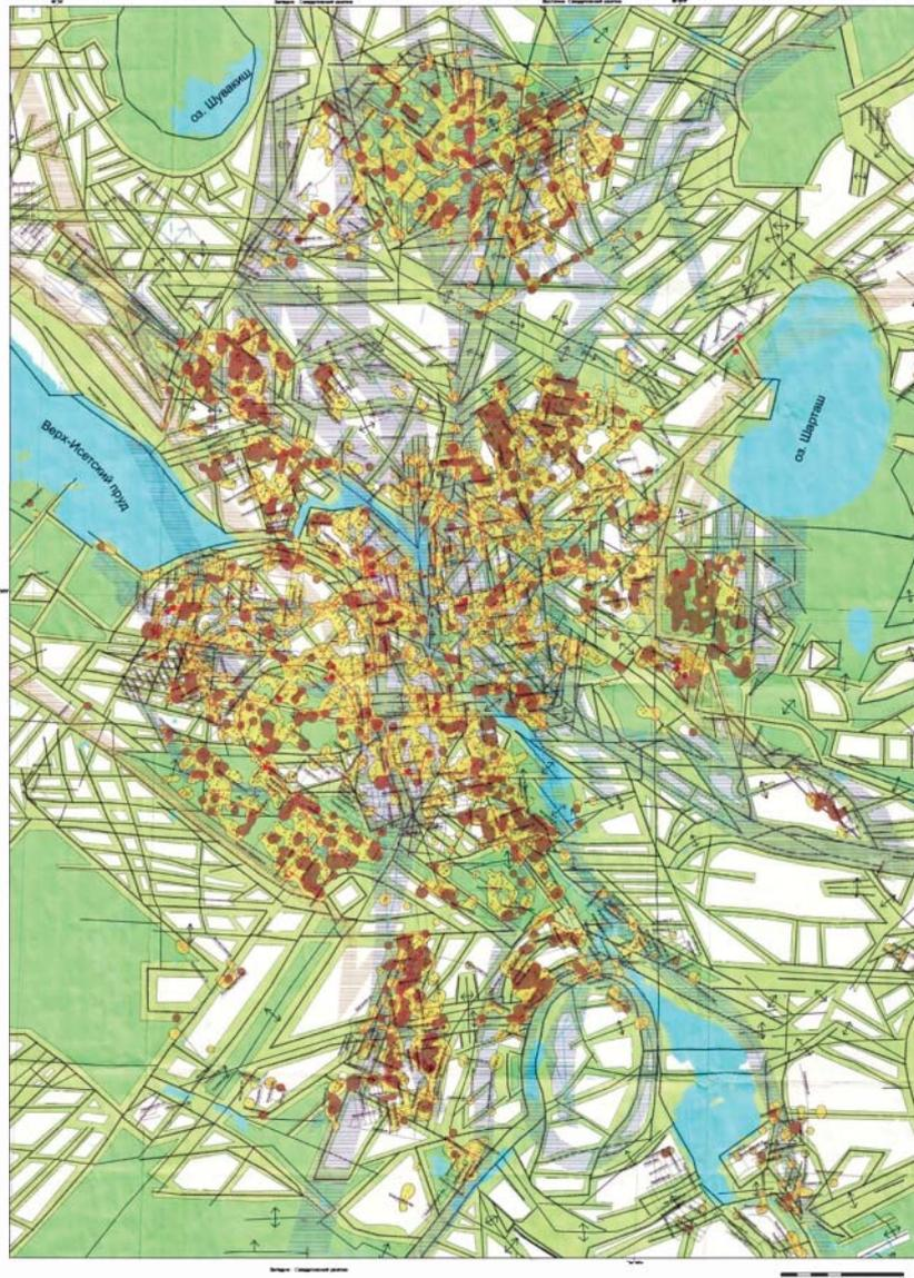
Рис. 1. Схематическая карта аварий на линиях городского водопровода Екатеринбурга за 1995 – 2005 гг., совмещенная со структурно-геоморфологической схемой.
